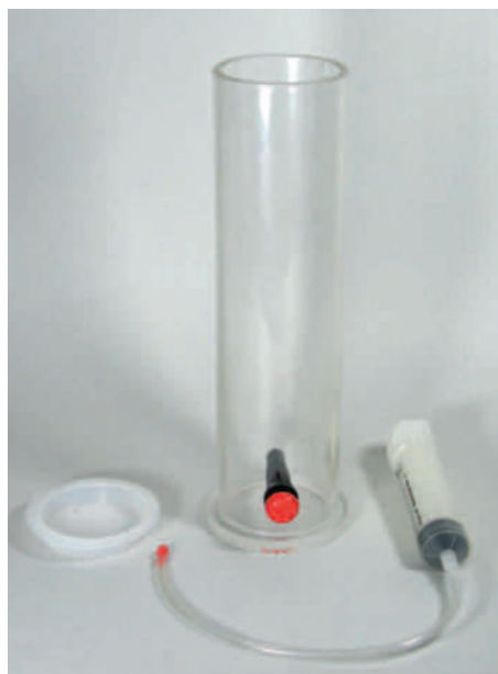
Zündrohr mit 50 ml-Spritze und Schlauch für Feuerzeuggas-Abfüllung
