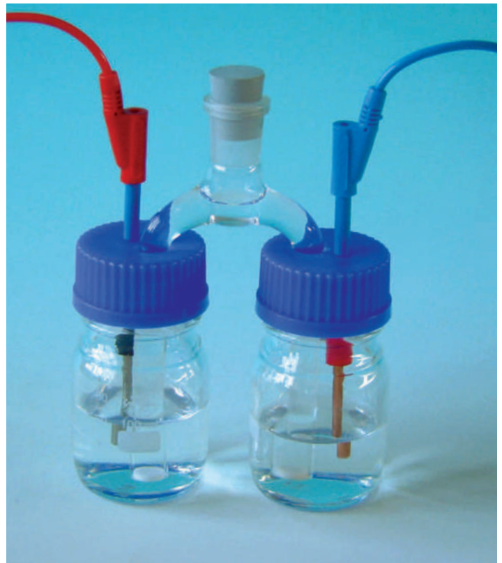
Die Messflaschen werden mit einem Stromschlüssel verbunden
