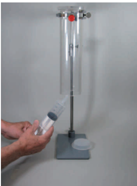
Einfüllen von Wasserstoff (leichter als Luft)
