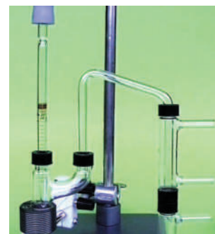
Wesentliche Teile einer Apparatur zur Diethylethersynthese
