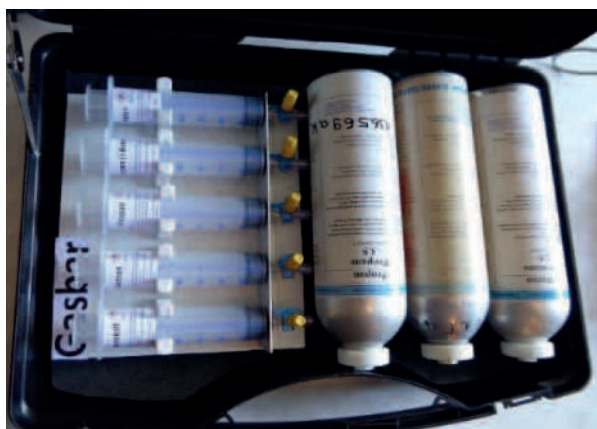
Erweiterung 1: Die "Gasbar" mit Reingas-Druckdosen zur Identifizierung ist im unteren Teil des Koffers untergebracht.
