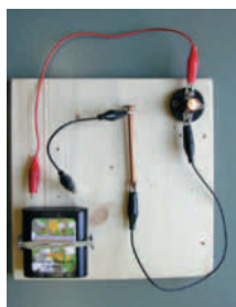
Leitfähigkeitsuntersuchung eines Nagels
