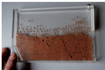
Modell - fester Zustand, Kristallite, Gitterfehlstellen, Verdampfen
