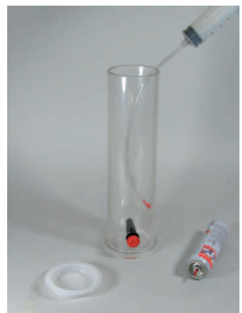
Einfüllen von Feuerzeuggas (schwerer als Luft)
