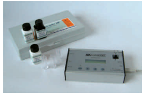
Fotometrische Bestimmung mit Standard-Reagenziensätzen wie z.B. VISOCOLOR®, Aquanal etc.
